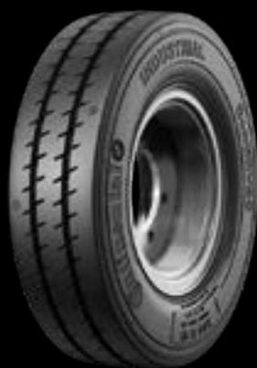
El ContiRV20 Industrial está especialmente diseñado para trabajos pesados con carretillas elevadoras usadas en entornos duros.
