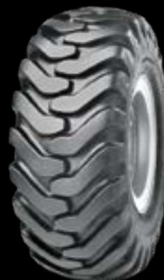
Los tacos del IC30 están contruidos con un compuesto de caucho duro y resistente al desgaste que garantiza el kilometraje.
