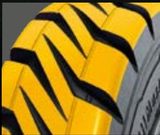
**Diseño de los tacos de la banda de rodadura**
