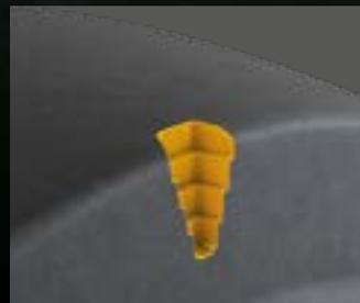
**Indicador de desgaste del dibujo (TWI)**
