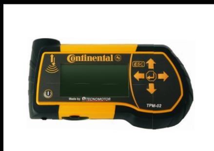
Se usa para configurar inicialmente el sistema e inspeccionar sin cables el sensor.
